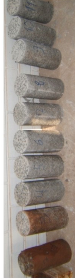
Figura 1. Corpos-de-prova do modelo de estaca com presença de lama
