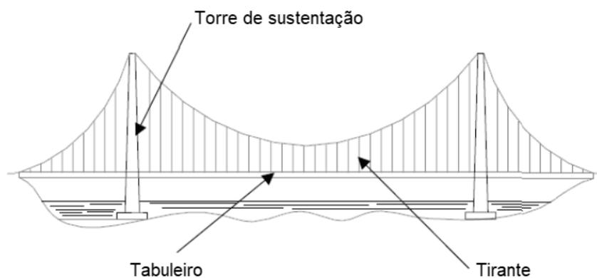
Uma ponte com torres de sustentação de 50 metros de altura acima do tabuleiro, separadas por uma distância de 250 metros. O ponto mais baixo de cada cabo está a 5 metros acima do leito do tabuleiro. Determine o tamanho do tirante que está localizado a 50 metros de distância de uma das torres de sustentação?
